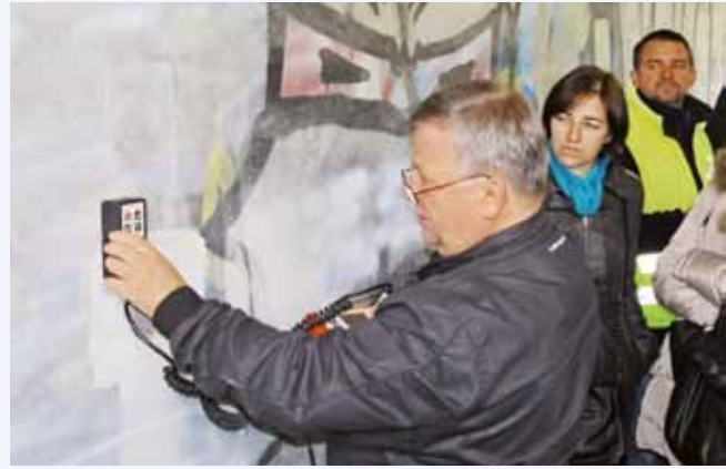
Detekcja zbrojenia przy użyciu profometera
