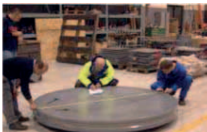
Ryc. 4. Łożysko przewidziane na most w Płocku podczas pomiarów w wytwórni
