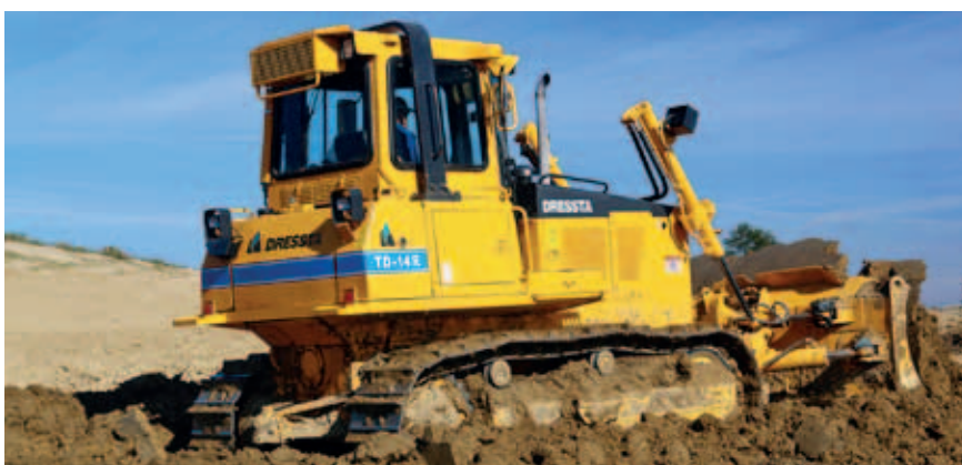
Najnowszy model stalowowolskiej spycharki gaśnicowej TD-14M Extra o mocy silnika 160 KM i pojemności lemiesza do 4,28 m 3
