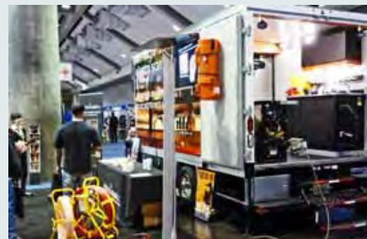
Ryc. 7. Zestaw badawczy do elektroskowania przewodów kanalizacyjnych
