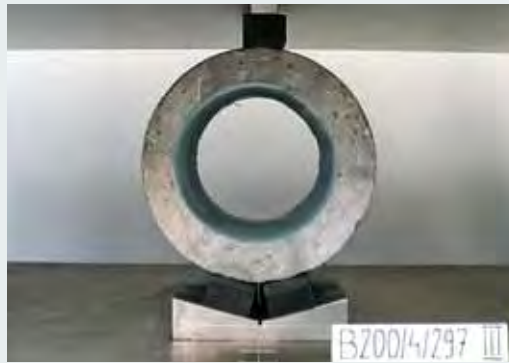
Ryc. 11. Badanie laboratoryjne rury betonowej z rehabilitacją powłoką żywiczną w laboratorium Katedry Sieci i Instalacji Sanitarnych Politechniki Świętokrzyskiej
