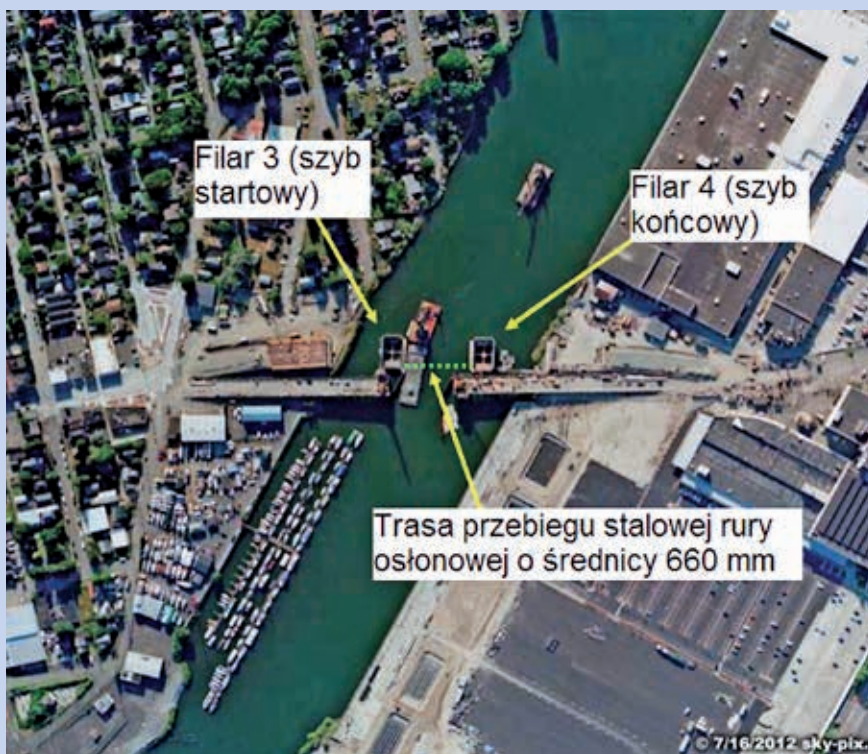
Ryc. 9. Zdjęcie satelitarne placu budowy z zaznaczonymi przyszłymi filarami mostu oraz trasą przebiegu przewiertu. Poniżej nowo budowanego mostu widoczne są pozostałości starej przeprawy [6]
