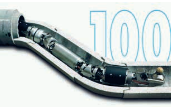
Ryc. 9. Robot kanalizacyjny stosowany w przewodach kanalizacyjnych o średnicy 100 mm
