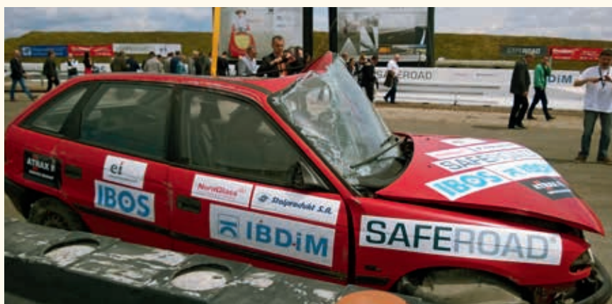
Samochód po uderzeniu w połączenie bariery stalowej i betonowej starego typu
