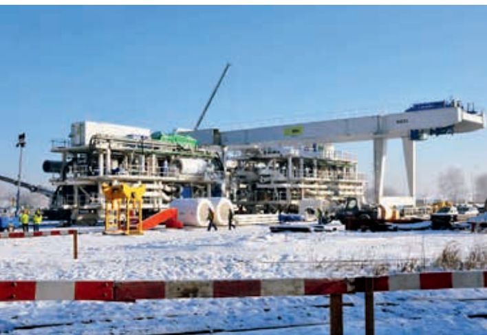
Ryc. 1. Maszyna TBM wraz z tarczą o średnicy ok. 13 m na placu budowy tunelu pod Martwą Wisłą, fot. archiwum WGiG AGH
