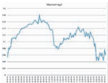
Ryc. 4. Wykres z monitoringu online realizowanego w jednym ze stałych punktów sieci obrazujący zmiany mętności wody w czasie
