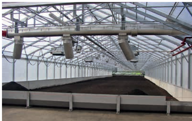
Wnętrze hali suszarniczej w technologii IST-Anlagenbau z automatycznym systemem podawania odwodnionych osadów do suszarni, fot. IST-Anlagenbau GmbH, EUROTECH Katarzyna Trojanowska
