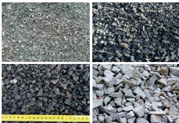
Ryc. 2. Kruszywa łamane: a) kliniec piaskowy 0–31,5 mm, b) tłuczeń porfirowy 31,5–63 mm, c) grys bazaltowy 8–16 mm, d) kamień łamany granitowy
