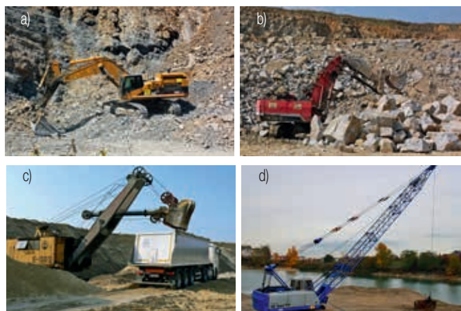
Ryc. 7. Jednonaczyniowa koparka: a) hydrauliczna podsiębierna – Caterpillar 365C, b) hydrauliczna nadsiębierna – O&K RH3-E (fot. A. Borcz), c) mechaniczna (linowa) – Skoda E-303 [2], d) zgarniakowa – Nobas UB 1254 [9]
