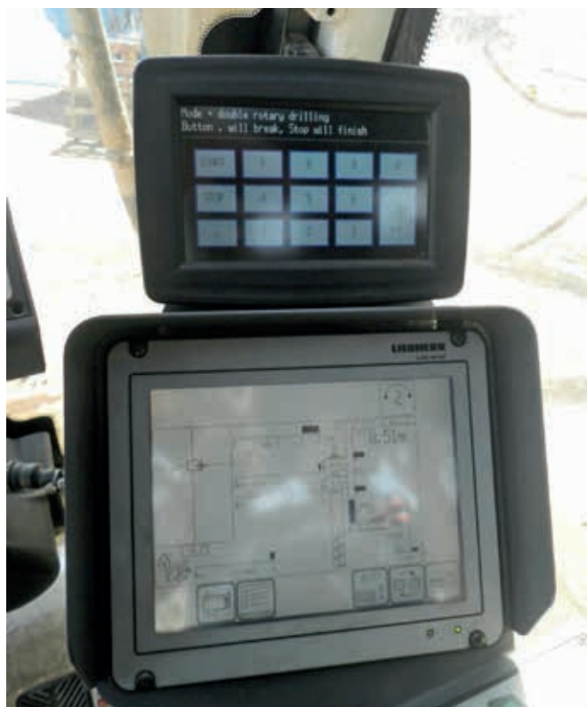
Ryc. 4. Monitoring wykonywania kolumn CMC
