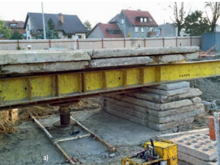
Ryc. 6. Stanowisko do próbnych obciążeń statycznych: a) montaż, b) w trakcie badania
