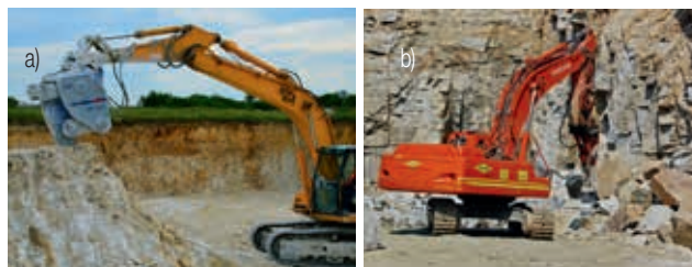
Ryc. 13. Mechaniczne urabianie skał z użyciem a) zrywaka wibracyjnego [4], b) młota hydraulicznego, fot. A. Borcz
