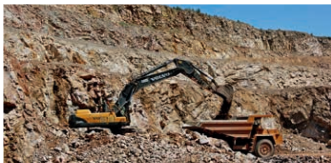
Ryc. 10. Współpraca koparki podsiębiernej Volvo z samochodem Białez w kopalni wapienia, fot. A. Borcz
