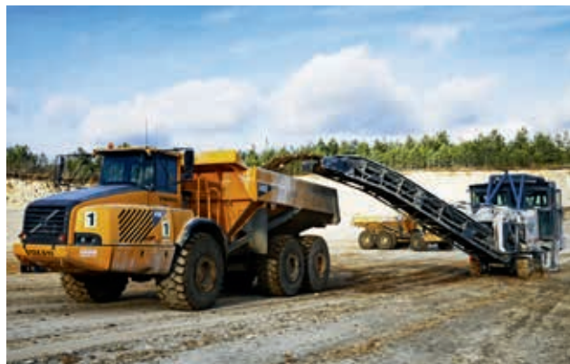
Ryc. 11. Kombajn frezujący Wirtgen 2200 z bezpośrednim ładowaniem urobionej kopaliny na wozidło, fot. M. Sikora
