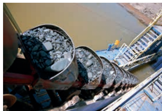
Ryc. 16. Pogłębiarka wieloczerpakowa w kopalni kruszyw zwirowych eksploatowanych spod wody, fot. A. Borcz
