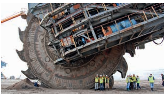
Ryc. 6. Koło czepakowe koparki wielonaczyniowej kołowej w kopalni węgla brunatnego, fot. A. Borcz
