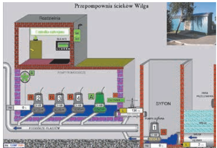
Ryc. 1. Układ technologiczny pompowni ścieków Wilga
