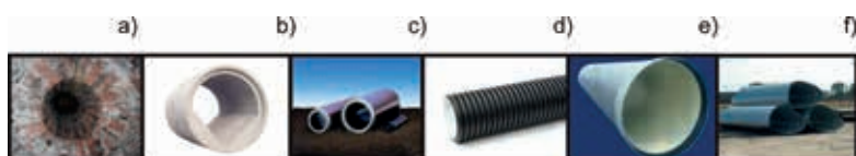
Ryc. 7. Przykładowe materiały stosowane do budowy dolnych przejść dla zwierząt w infrastrukturze komunikacyjnej: a) cegła, b) beton i żelbet, c) kamionka, d) tworzywa sztuczne (PE, PEHD), e) materiały kompozytowe (GRP), f) blachy faliste
