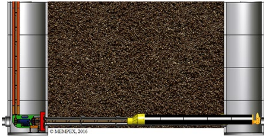
Wymiana rurociągu „ze studni do studni”. Maszyna ST-40 jest umieszczona w studni roboczej (po lewej stronie)
