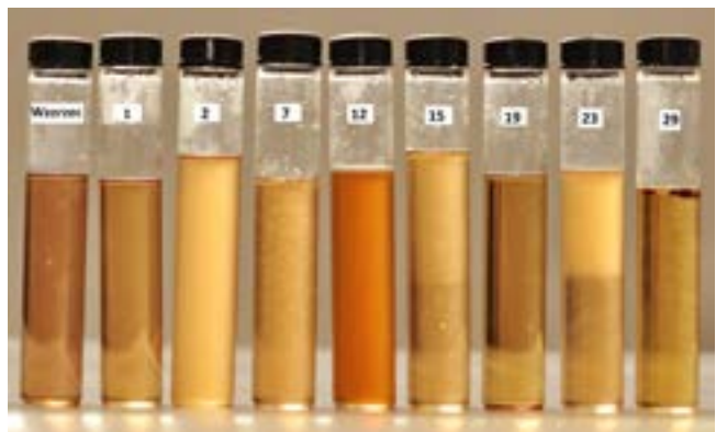
Ryc. 3. Próbkki domieszek po badaniu starzeniowym
