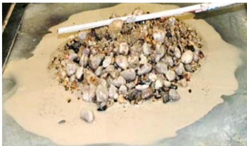
Ryc. 4. Efekt działania polimerowej domieszki MC-Montan Drive LB stabilizującej urobek żwirowo-piaskowy
