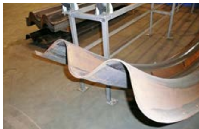
Ryc. 3. Przykładowy widok elementu konstrukcyjnego typu SuperCor® w fazie produkcji. Widoczna wysokość fali charakterystyczna dla tego typu przekroju, fot. A. Wysokowski
