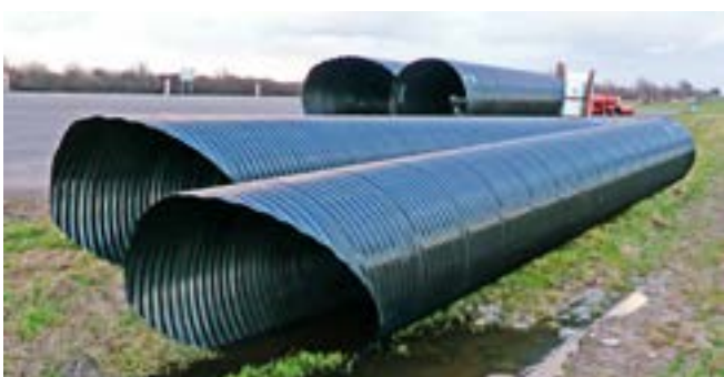
Ryc. 2. Widok konstrukcji powłokowych z rur spiralnie karbowanych. Widoczne ukształtowane na etapie produkcji skosy wlotu i wylotu przepustu, zgodnie z projektowym nachyleniem skarpy, fot. A. Wysokowski
