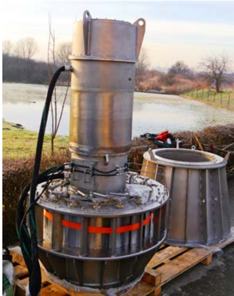
Turbina przygotowana do montażu
