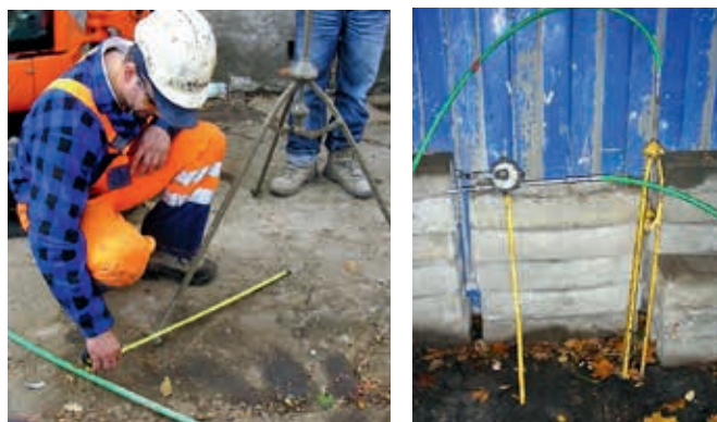
Ryc. 19 i 20. Parasol pomiarowy: (po lewej) pomiar średnicy świeżo wykonanej kolumny, (po prawej) widok urządzenia pomiarowego
