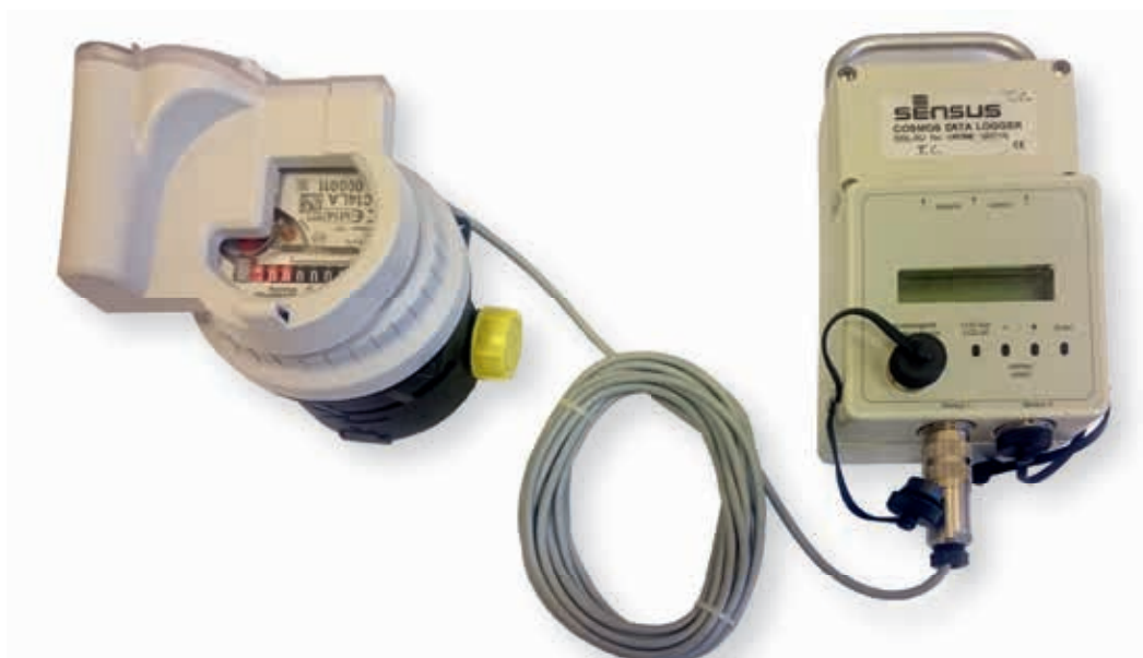
Wodomierz podłączony do rejestratora chwilowych natężeń przepływu, za pomocą którego bada się, czy w instalacji lub sieci występują wycieki
