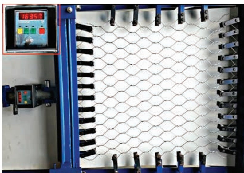
Ryc. 3. Arkusz siatki heksagonalnej Nector Hard 3.0, poddany próbie
