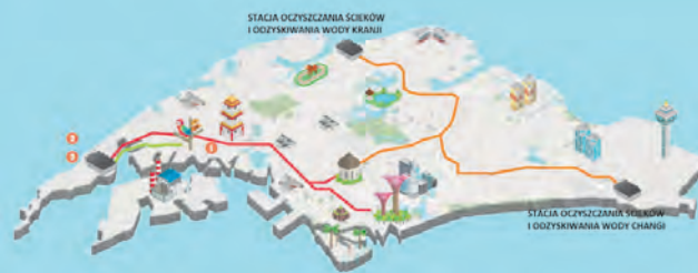
Ryc. 1. Przebieg wybudowanych i planowanych tuneli do przesyłania ścieków w Singapurze [2]
