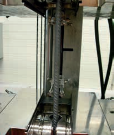
Maszyna wytrzymałościowa w trakcie statycznej próby rozciągania
