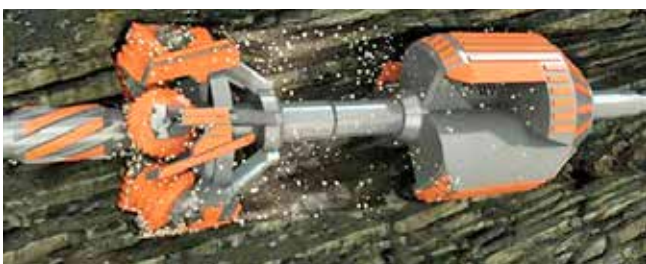
Ryc. 3. Pompa DHJP umieszczona za rozwiertakiem [8]
