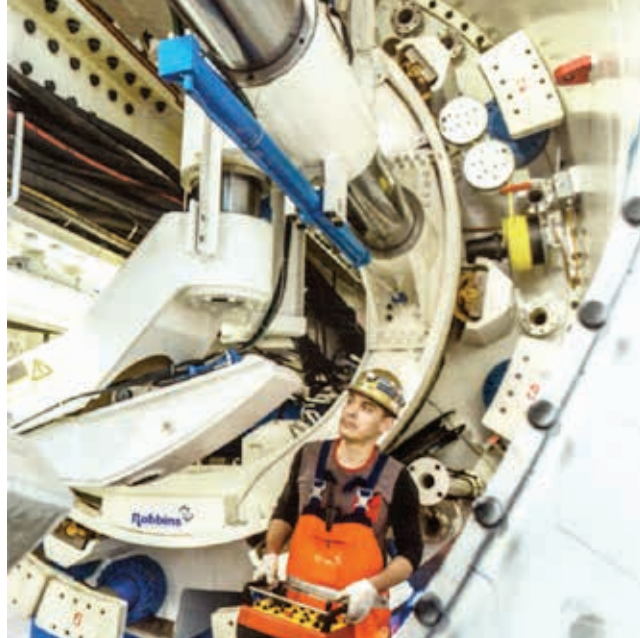
Ryc. 5. System sterujący głowicy TBM firmy Robbins [1]
