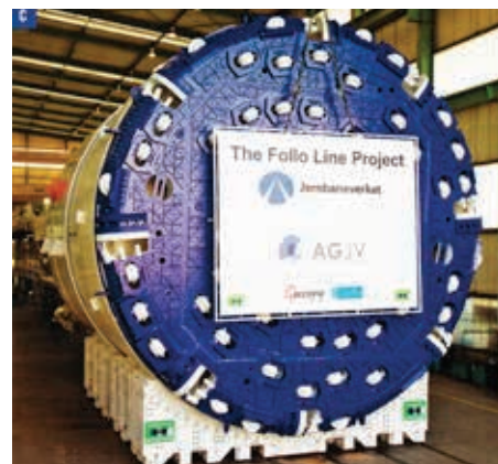
Ryc. 5. Jedna z głowic TBM, która została zaprojektowana i wyprodukowana na potrzeby projektu Follo Line w Norwegii
