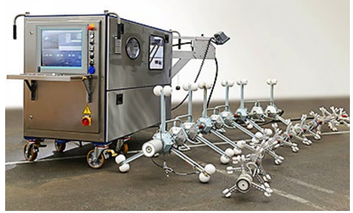
Ryc. 9. Urządzenie do utwardzania powłok żywic UV REE2000 Mobile 150 [6]
