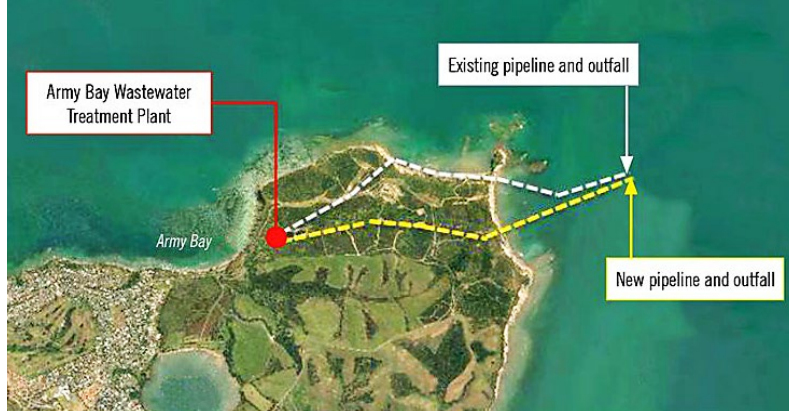
Ryc. 4. Istniejący i nowo budowany kanał zrzutowy ścieków [8]
