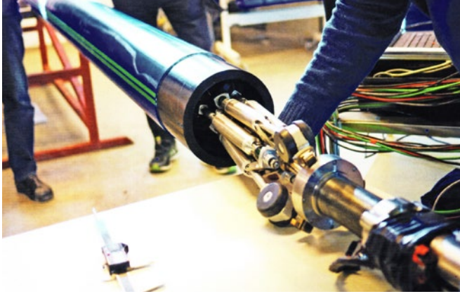
Ryc. 2. Urządzenie Hawle NoDig System testowane w warunkach laboratoryjnych [3]
