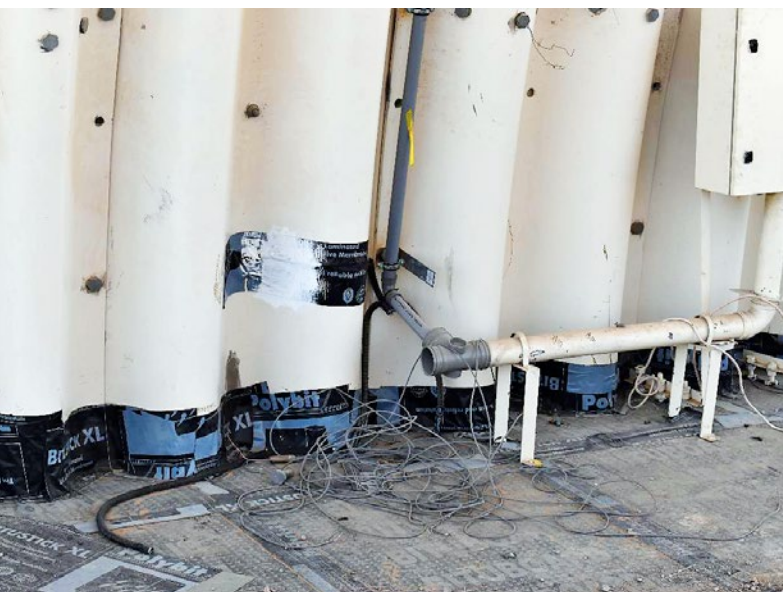
Ryc. 2. Instalacja tensometrów elektrooporowych i system pomiarowy
