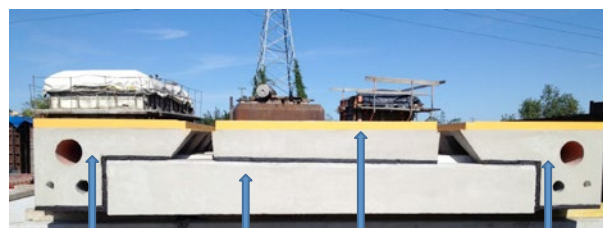
Płyta kolejowo-drogowa skrajna prawa PKD2-49E1 0,868x2,99x0,491(0,195±0,205m) Płyta kolejowo-drogowa środkowa PKD1-49E1 1,330x2,99x0,182±0,198m Płyta kolejowo-drogowa skrajna prawa PKD2-49E1 0,868x2,99x0,491(0,195±0,205m) Płyta torowa (podtorowa) przejazdowa Pt1p-49E1 2,50x2,99x0,29±0,32m
