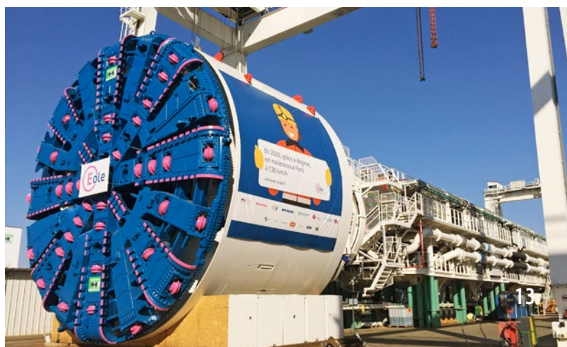
Ryc. 6. Tarcza typu EPB o średnicy 12 m wyprodukowana do budowy linii RER Eole (zaznaczonej kolorem różowym na ryc. 4), fot. A. Siemińska-Lewandowska
