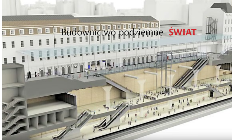
Ryc. 3. Jedna ze stacji Elisabeth Line zbudowana pod istniejącą zabudową i ulicą o dużym natężeniu ruchu, źródło: www.crossrail.uk
