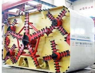
Ryc. 13. Prostokątne urządzenie tarczowe [26]
