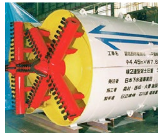
Ryc. 10. Urządzenie tarczowe typu DOT [14]
