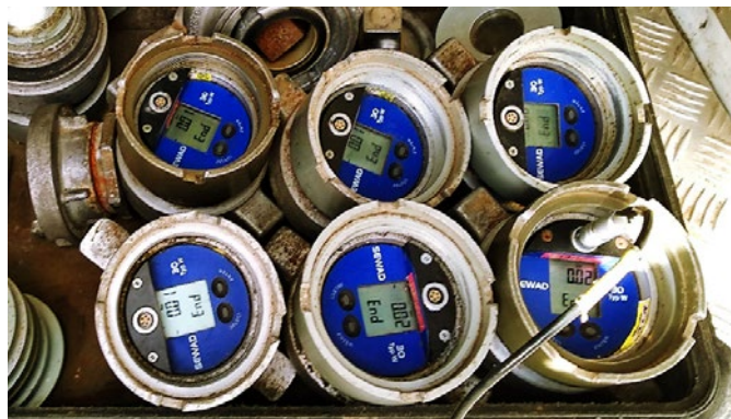
Urządzenia do pomiaru ciśnienia użyte w ramach zrealizowanej kampanii pomiarowej
