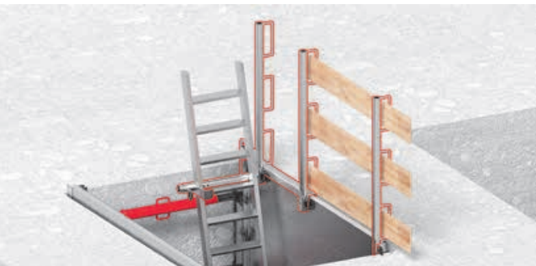
Ryc. 7. Bezpieczne zejście do wykopu
