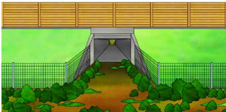
Ryc. 2. Przykładowy schemat zagospodarowania przepustu o funkcji ekologicznej według przepisów obowiązujących w Hiszpanii [17]
