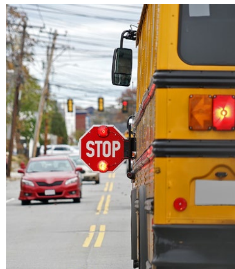
Ryc. 6. Sygnał może być podany ręcznie bądź przez odsłonięcie znaku STOP na autobusie, fot. nd700/Adobe Stock
