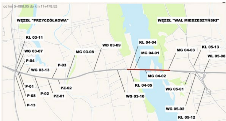
Zadanie B obejmuje budowę fragmentu drogi o długości 6,45 km od węzła Przyczółkowa do węzła Wał Miedzeszyński wraz z węzłami oraz mostu przez Wisłę
