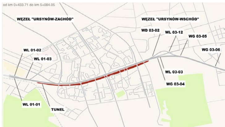
Zadanie A obejmuje budowę fragmentu drogi o długości ok. 4,6 km od węzła Puławska (bez węzła) do węzła Przyczółkowa (bez węzła), węzłów Ursynów Zachód i Ursynów Wschód oraz tunelu pod Ursynowem
