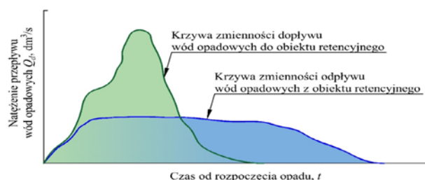
Ryc. 1. Graficzna charakterystyka zmienności przepływu wód opadowych w sieci kanalizacyjnej potwierdzająca zasadność funkcjonowania obiektów retencyjnych
