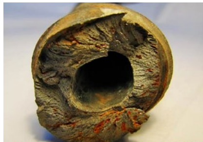
Żerdź uszkodzona jeszcze podczas instalacji. W tym przypadku defekt jest oczywisty i łatwy do naprawienia przez wymianę uszkodzonej żerdzi. Jaka będzie trwałość całej konstrukcji opartej na tym materiale, łatwo się domyślić
