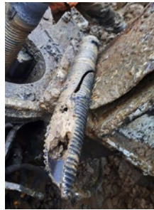
Żerdź uszkodzona jeszcze podczas instalacji. W tym przypadku defekt jest oczywisty i łatwy do naprawienia przez wymianę uszkodzonej żerdzi. Jaka będzie trwałość całej konstrukcji opartej na tym materiale, łatwo się domyślić
