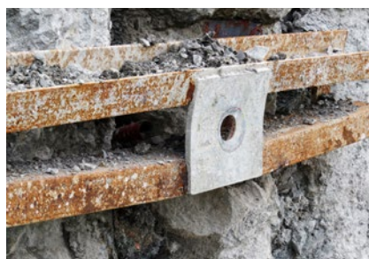
Awaria konstrukcji spowodowana brakiem deklarowanej wytrzymałości i wydłużenia żerdzi
