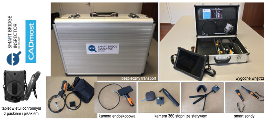
Ryc. 5. Skrzynka inspektora mostowego z urządzeniem bazowym i dodatkowym wyposażeniem
