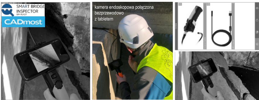
Ryc. 13. Praca z kamerą endoskopową połączoną bezprzewodowo z tabletem
