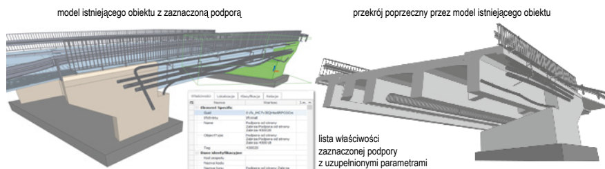
Ryc. 10. Model BIM mostu na Kłodnicy w Gliwicach
